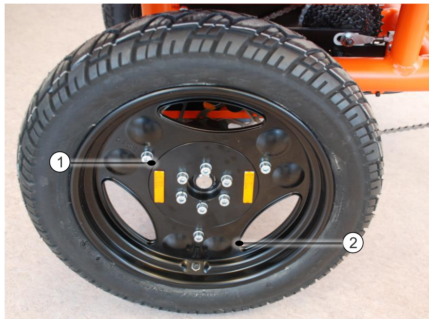
Abbildung 13 Hinterrad Allround, Work 2.0 / 3.0 / 3.1 mit Schrauben befestigt
