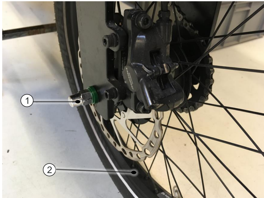
Abbildung 14 Hinterrad Life mit Schrauben befestigt
