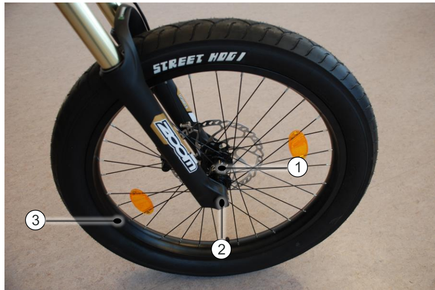
Abbildung 12 Vorderrad mit Steckachse befestigt
